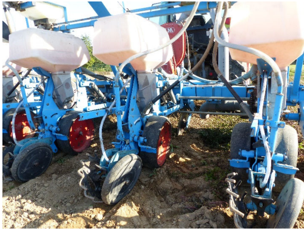
Photo 1 : semis de la moutarde et du sorgho avec un semoir à maïs
