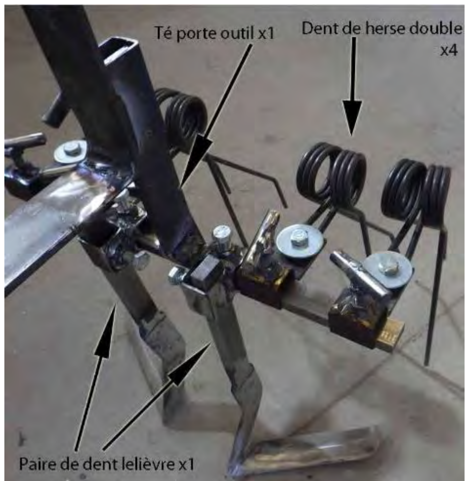
Figure 10 : Exemple de combinaison d'outils sur la houe maraîchère
