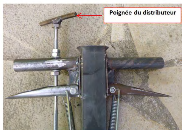
Figure 24 : Schéma et photo du distributeur d'engrais de la canne à planter modèle Guyane
