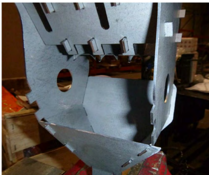
Figure 39 : Le distributeur de graines : assemblage par tenon mortaise sans soudure
