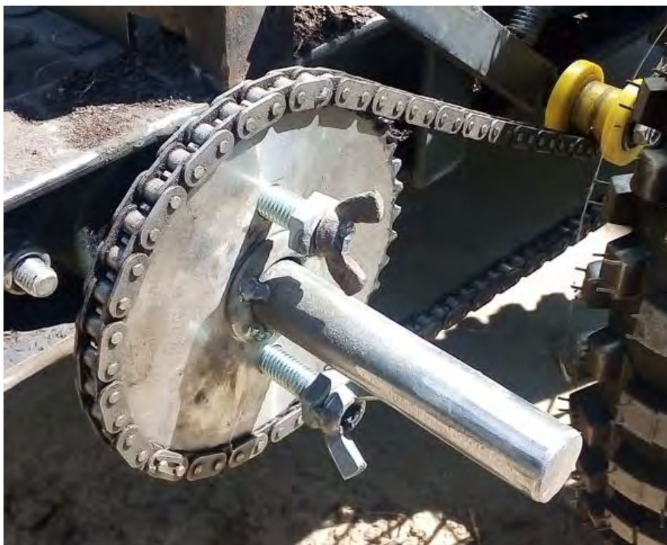
Figure 63 : Aperçu du système d'embrayage/débrayage
