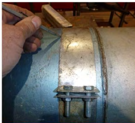
Traçage des bouteilles de gaz avec gabarit avant découpe
